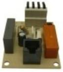
**Placa Electrónica Base Bomba Desagüe Fcs**
